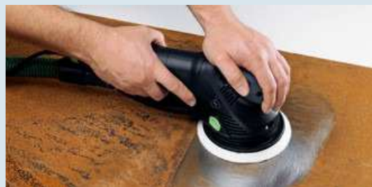
Preparazione di ferro arrugginito con una levigatrice rotorbitale.
